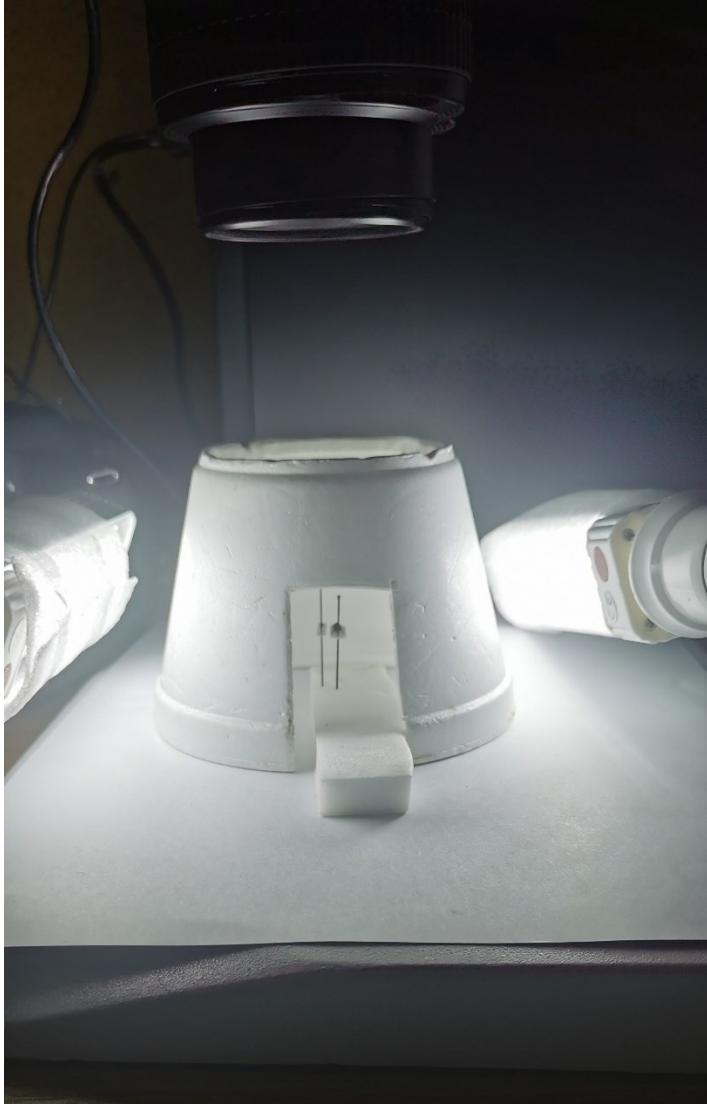
Abbildung 3: Angebrachter Lichtdiffusor (Styroporbecher). Objekt in der Mitte gesteckt.
