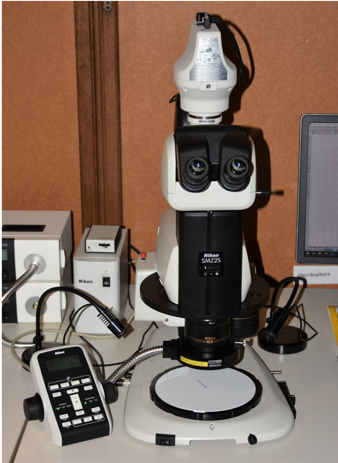
Abb. 1: Nikon SMZ25 Stereomikroskop mit montiertem Kamerablock (Nikon DS-Ri2), Fernbedienung und externen Lichtquellen (Ringlicht und LED-Lampen).
