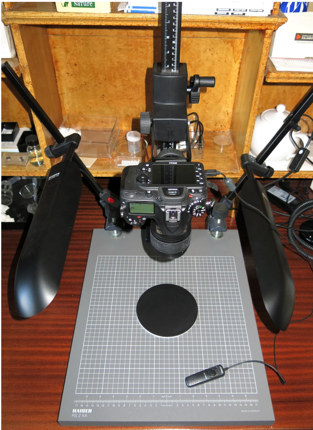
Abb. 1: Nikon D7200 Spiegelreflexkamera montiert auf Kaiser Repröstativ, mit zwei verstellbaren Kaltlichtleuchten, Fernauslöser und schwarz-weißer Objektplatte auf dem Stativtisch.
